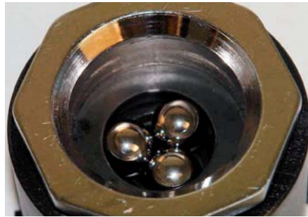
Kugeltopf mit Standkugeln – gefüllt mit Öl
